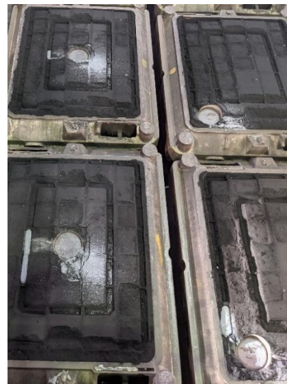
Figura 6: accumulo di inoculante sopra la motta a fine colata
